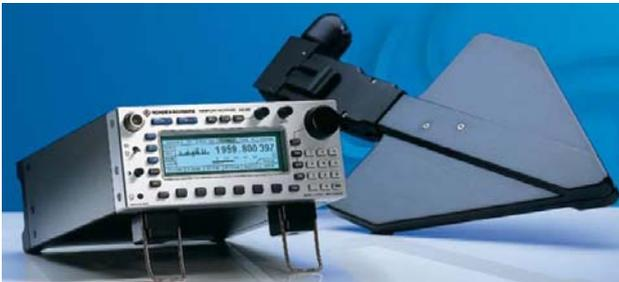
È un sistema utilizzato per monitorare e localizzare le sorgenti che emettono campi elettromagnetici da 10 kHz a 3 GHz e per rilevare eventuali segnali interferenti.
