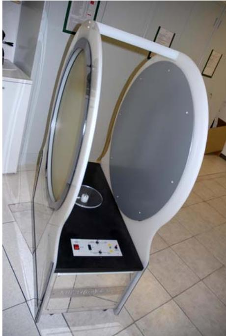
Tale sistema è in grado di generare un campo stabile in intensità e frequenza utile per calibrare i sensori e le sonde di campo elettrico e di campo magnetico presenti nel Servizio
