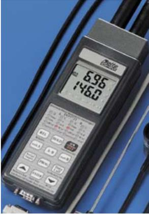
È un dispositivo per la rilevazione di illuminamento, irradianza, luminanza. La funzione Data Logger dello strumento permette l'acquisizione di dati scaricabili ed elaborabili su PC.
