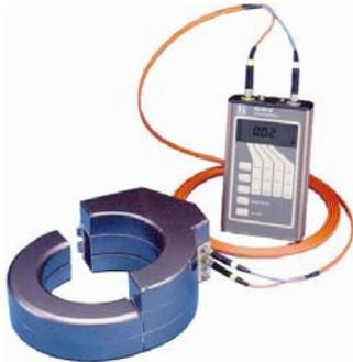
È uno strumento che permette di rilevare mediante una cavigliera collegata ad un display digitale il valore in banda larga della corrente indotta negli arti in presenza di sorgenti di campo elettromagnetico tra i 3 kHz e i 100 MHz
